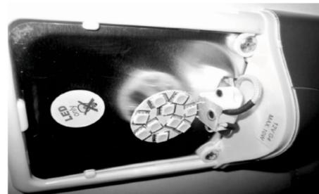
Abb. 153: LED-Leuchtmittel einsetzen
