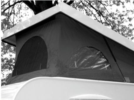
Abb. 36: Aufstelldach, aufgestellt
