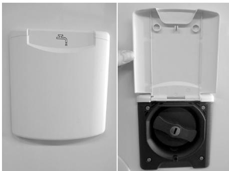
Abb. 20: Frischwassereinfüllstutzen
