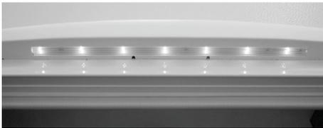
Abb. 61: Vorzeltleuchte mit Leuchtdioden
