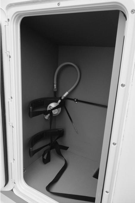
Abb. 65: Gaskasten, Beispiel
